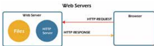
Gambar 9. Akses data oleh client ke source menggunakan fasilitas web server (sumber: JavaTpoint, 2021).
