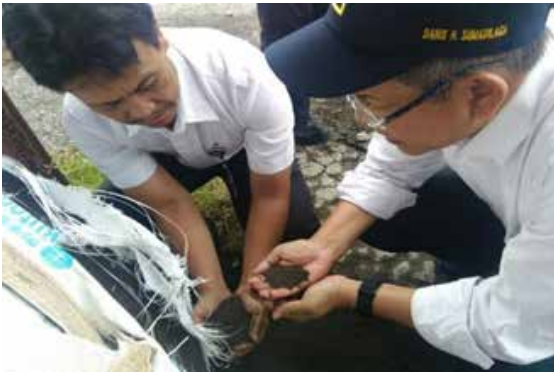
Gambar 13. Asbuton B 5/20 Tidak Menggumpal Selama Penyimpanan Meski Sampai Tampak Kemasaannya Lapuk
