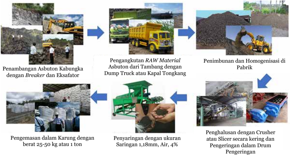
Gambar 7. Bagan Alir Skema Produksi Asbuton B 5/20
