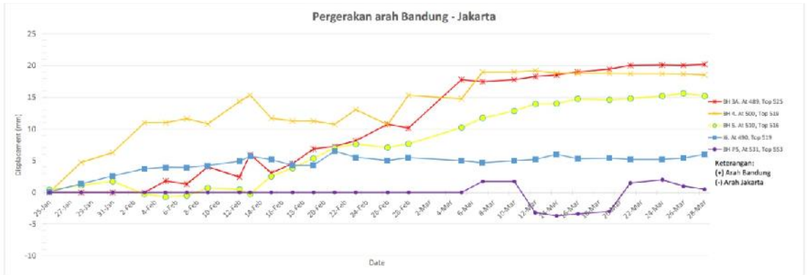
Gambar 13. Rekapitulasi Pemantauan Pergerakan Tanah Menggunakan Inklinometer
