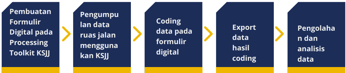
Gambar 2. Prosedur pengumpulan dan pengolahan data LFJ menggunakan KSJJ (Tanan, Putranto, Solihin, 2019)
