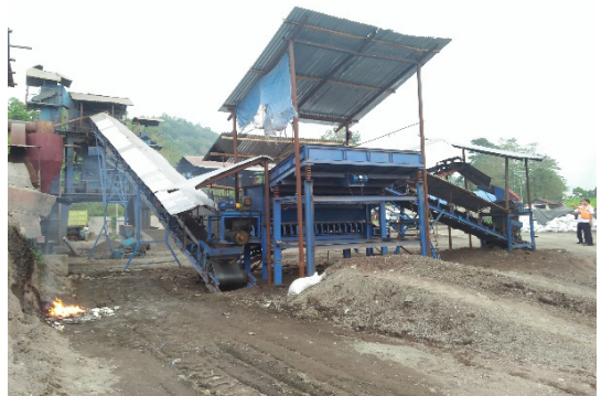
Gambar 6: Beberapa Contoh Unit Pencampur Aspal yang Dilengkapi Feeder System
