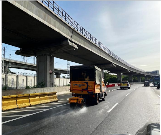
Pengujian Keesatan Jalan dengan menggunakan Alat Mu- Meter di ruas Jalan Tol Jakarta - Cikampek
