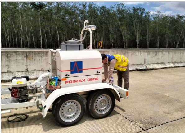
Advis Teknis Tinjauan Lapangan – Pendampingan Pengujian Alat HWD dan Evaluasi HWD Jalan Tol Palembang - Betung
