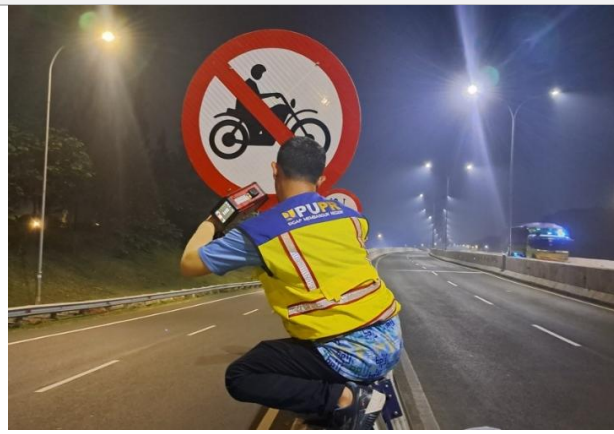
Pengujian Refleksi Rambu Jalan Flyover Akses Tol Cikarang Timur Jalan Tol Jakarta - Cikampek KM 37
