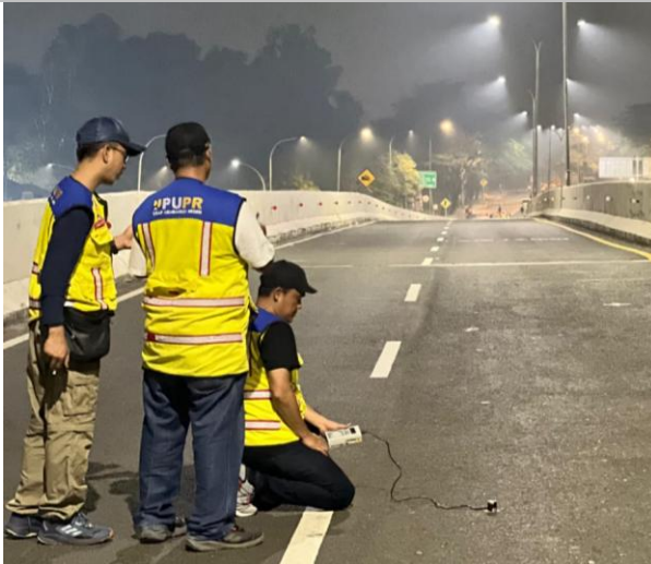
Pengujian Iluminansi Lampu Penerangan Jalan Umum (PJU) Flyover Akses Tol Cikarang Timur Jalan Tol Jakarta - Cikampek KM 37
