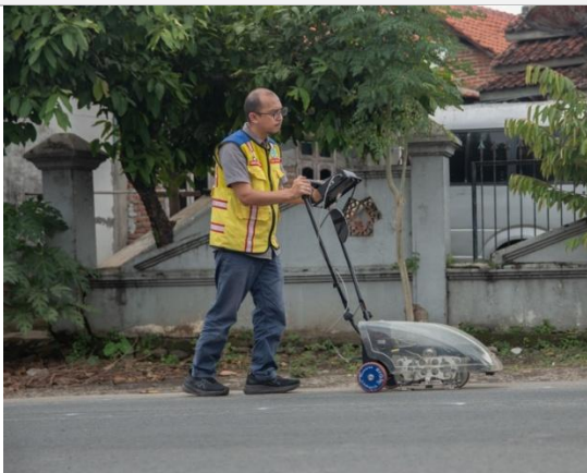
Pengujian Ketidakrataan dengan Alat Manual Kelas I di ruas Jalan Nasional Tegal
