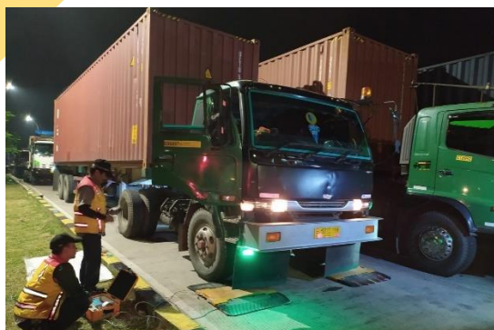
Survei berat sumbu dan pengukuran dimensi kendaraan di rest area
