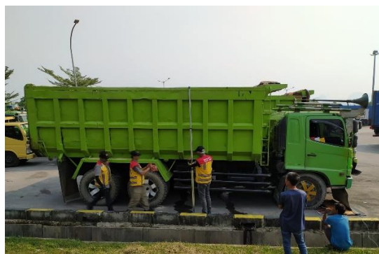
Survei berat sumbu dan pengukuran dimensi kendaraan di rest area
