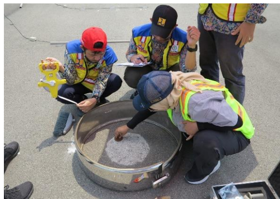
Pengujian Tekstur Permukaan Jalan
