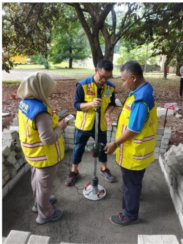
Pengujian Lendutan dengan *Light Weight Deflectometer*
