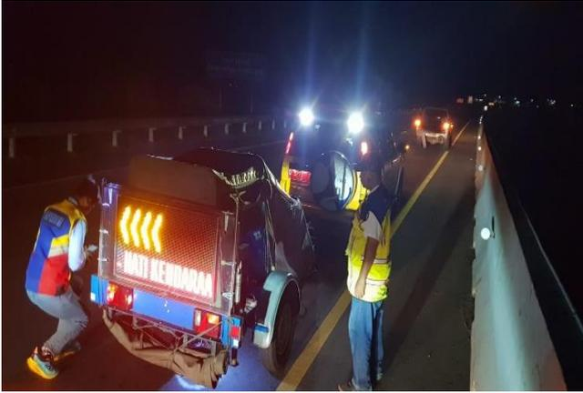
Pengujian Lendutan dengan *Falling Weight Deflectometer* di Jalan Tol Kayu Agung Palembang
