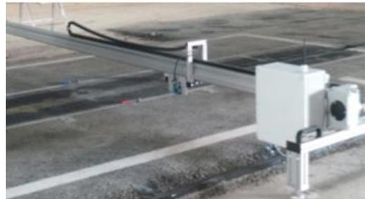
Pengukuran profil permukaan dengan Laser Profilometer
