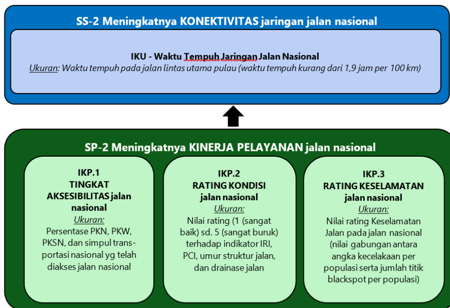
Gambar 2.3 Struktur dan Indikator Kinerja Ditjen Bina Marga 2020-2024 (1) Sumber: Renstra Ditjen Bina Marga 2020 – 2024
