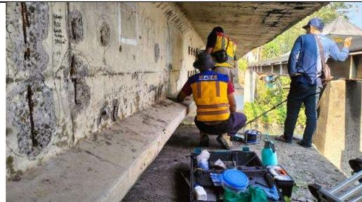
Pengukuran nilai potensial setengah sel pada beton gelagar jembatan Cikoneng dengan proteksi katoda Zn Cartridge
