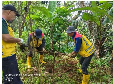
Penyelidikan Tanah Menggunakan Bor Tangan dan Pengambilan Sampel Tanah
