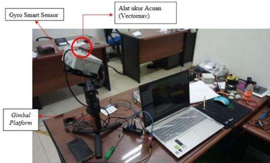
Pengujian Perangkat Keras Sensor Gyro
